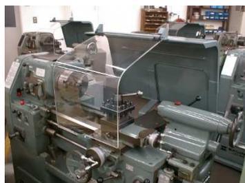
図2 安全カバーで作業性が悪化
