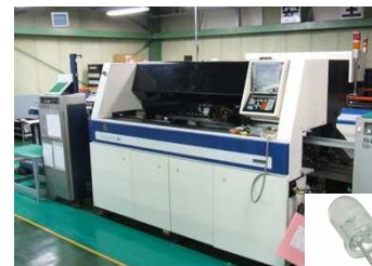
図3 ディスクリート部品挿入機と ディスクリート型LED部品
