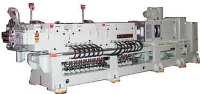
図8 高速回転2軸押出機
