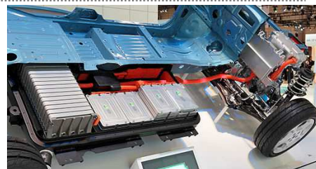
図1 リーフのリチウムイオン電池 (Nissan Leaf at the 2009 Tokyo Motor Show)
