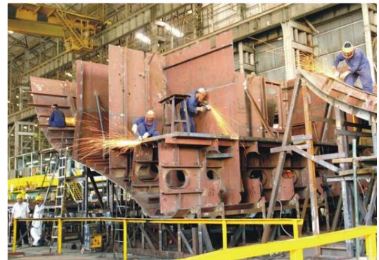
図6 ブロック工法で造られる船 (Wikipedia より)
