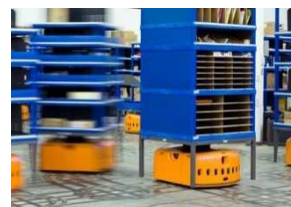
図4 アマゾン Kiva ロボット (Wikipedia より)
