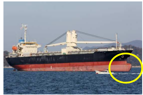
図6 球形の船首の現代タンカー
