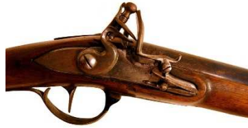
図4 火打ち式銃の発火装置 (Wikipedia より)
