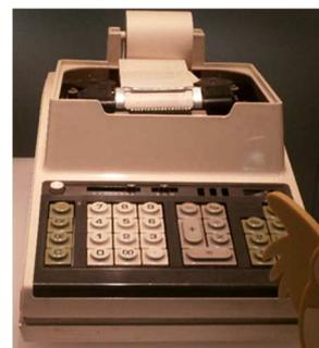
図 4 世界で最初にマイクロプロセッサを使用したビジコン 141
